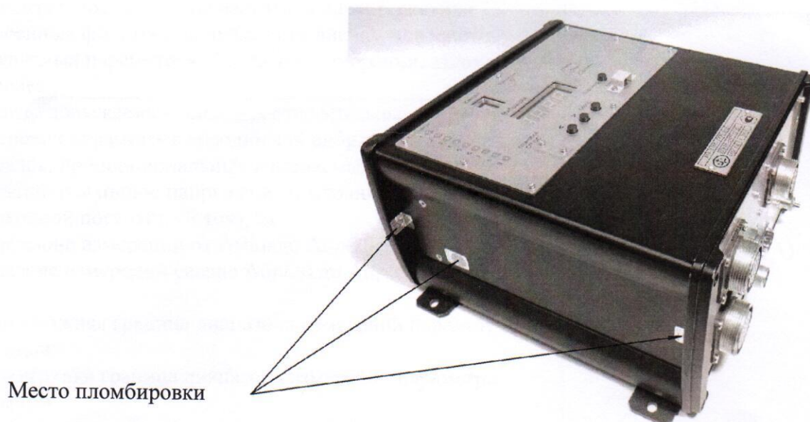
Рисунок 2 - Схема пломбировки от несанкционированного доступа
