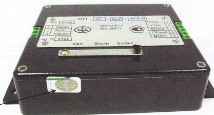
Рисунок 2 - Схема пломбировки от несанкционированного доступа, обозначения мест для нанесения оттисков клейм и нанесения наклеек
